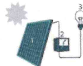
1. Zonnepaneel | 2. Omvormer 3. Elektrische toestellen
